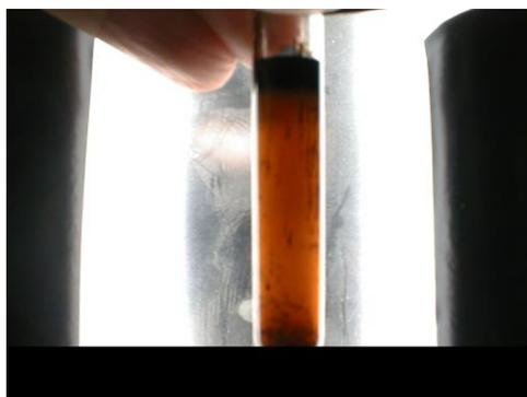
**Figura 1.** Fotografía de una mezcla de acuerdo a la invención, en la cual el hidrocarburo empleado en la obtención de la misma es un hidrocarburo pesado. En esta imagen se observa la separación de tres fases una vez que se ha dejado decantar la misma.
