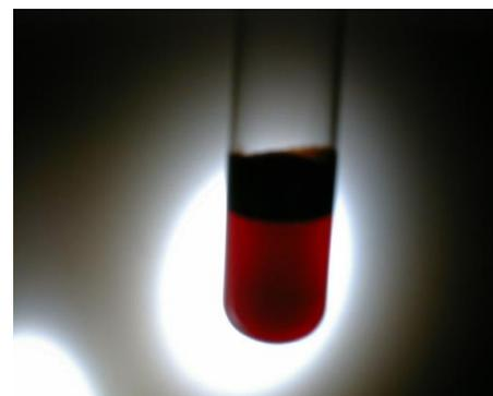
**Figura 2.** Fotografía de una mezcla de acuerdo a la invención, en la cual el hidrocarburo empleado en la obtención de la misma es un hidrocarburo mediano. En esta imagen se observa la separación de tres fases una vez que se ha dejado decantar la misma.
