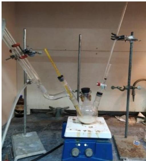
**Figura 1.** Equipo empleado en el proceso de polimerización en emulsión.
